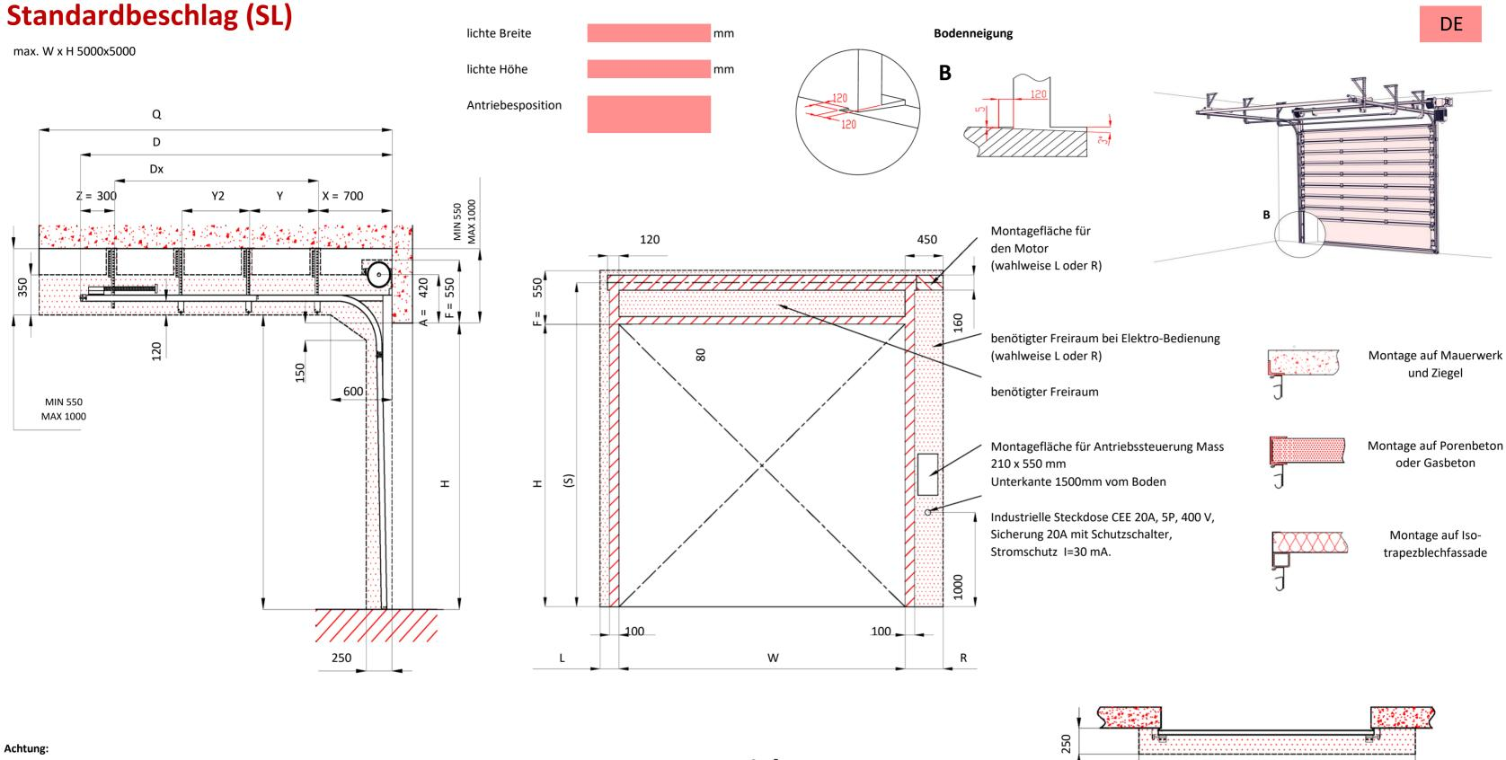
Fläche, an die montiert wird, muss gerade und fest sein und alle Montageflächen müssen in
